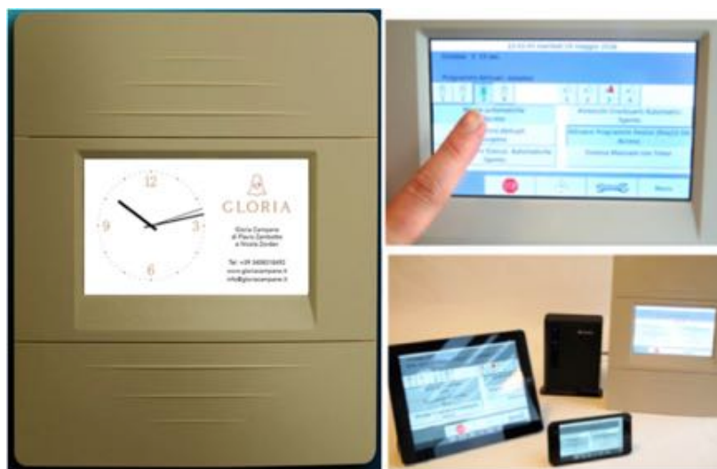
Programmatore touch screen controllabile da remoto
